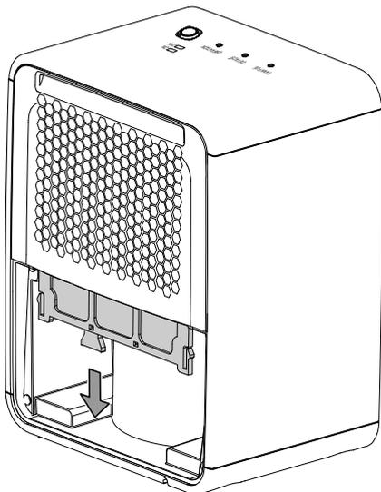
3. Nettoyez le filtre avec un chiffon doux légèrement humide non pelucheux. Si le filtre est très encrassé, nettoyez-le avec de l'eau chaude mélangée à un produit de nettoyage neutre.
