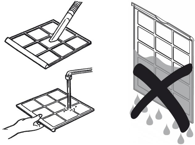
4. Laissez le filtre sécher complètement. N'insérez pas de filtre mouillé dans l'appareil.
