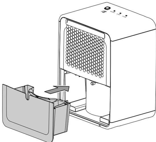
2. Videz le bac de récupération des condensats dans une conduite d'écoulement ou un évier.
